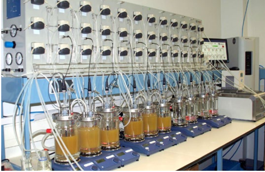
El simulador del ecosistema microbiano intestinal humano es actualmente la tecnología in vitro más efectiva para reproducir las propiedades fisiológicas, químicas y microbiológicas del tracto gastrointestinal.
