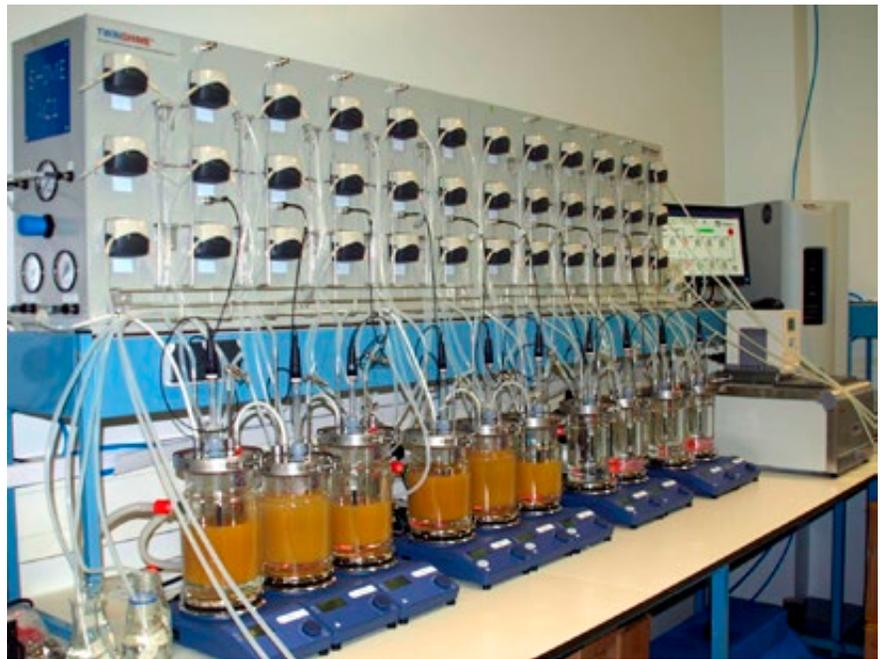
El dispositivo Twin-Shime puede simular en paralelo la digestión de dos muestras y emular cada una de las fases del colon: ascendente, transversal y descendente.
